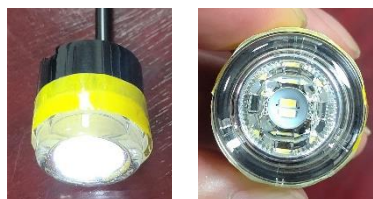
丸形LED基板に チップLEDを搭載
