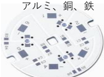
金属基板 アルミ、銅、鉄
